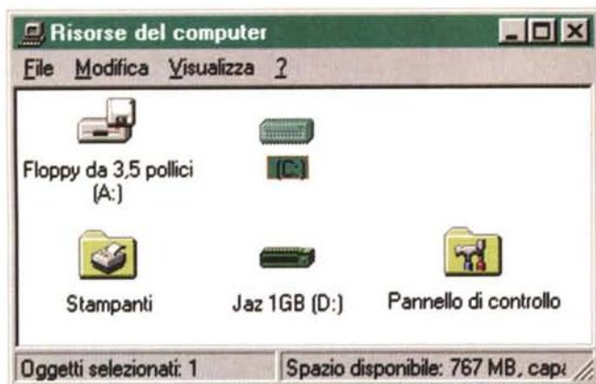
Al termine della procedura di installazione, aprendo in Windows 95 la finestra delle «Risorse del computer», appare una nuova icona corrispondente all'unità Jaz.
